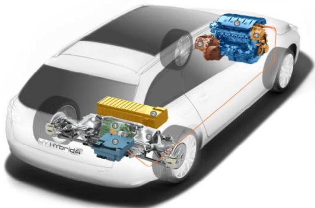
1. Moteur électrique (37ch / 27kW)
